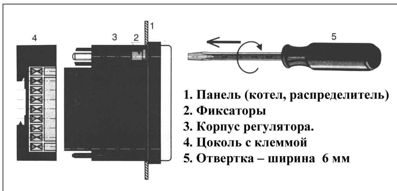
Рис. №5 - монтаж регулятора к панели
